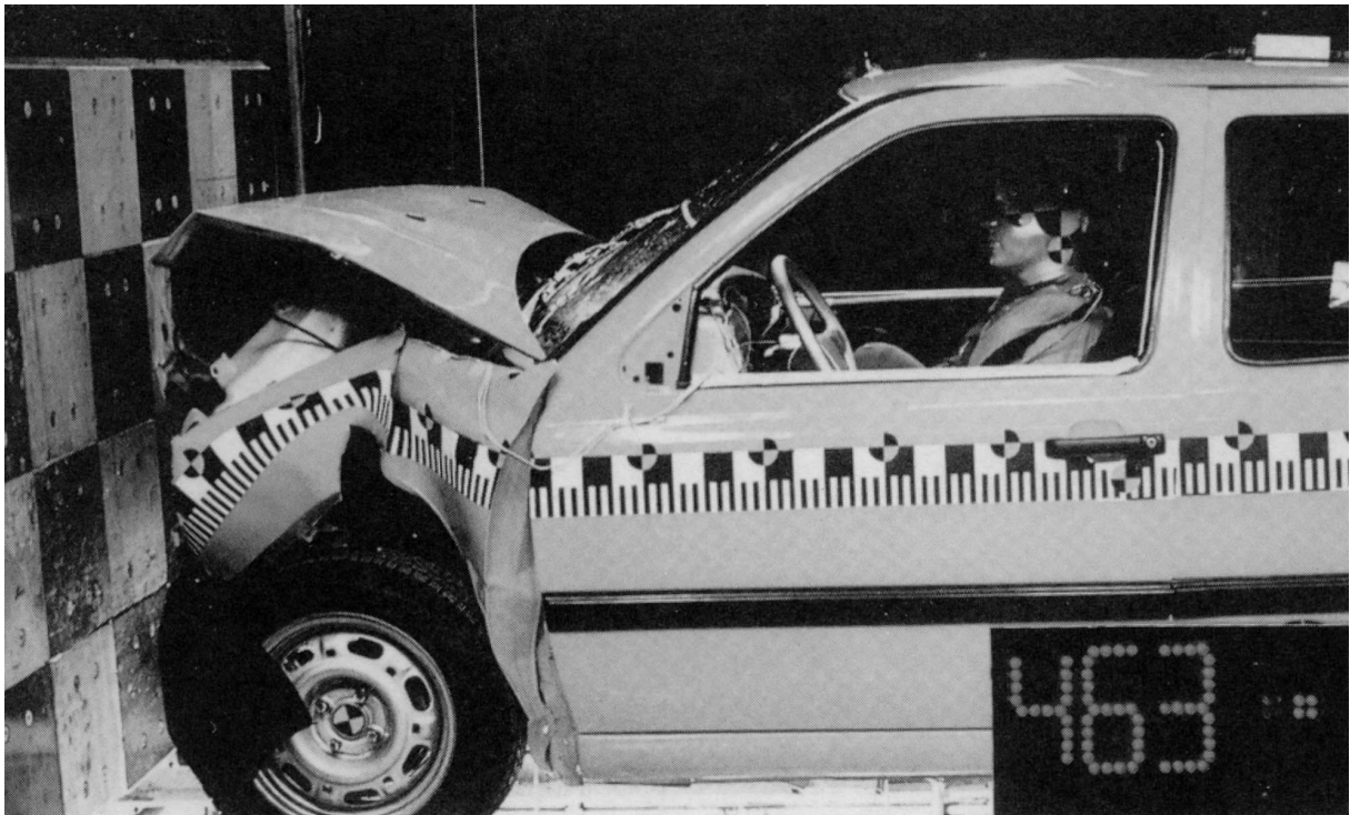
High-Speed-Display EFE im Crash-Versuch
